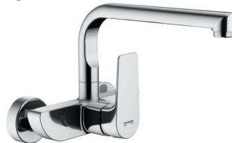
MONOCOMANDAMENT D'AIGÜERA MURAL 9704035 Cromat, per instal·lar en paret sobre l'aigüera. Amb cartutx ceràmic silenciós D40 amb sortida dirigida. Proveït d'un airejador plàstic anticalc amb casquet de llautó cromat. Inclou tots els elements de fixació.
