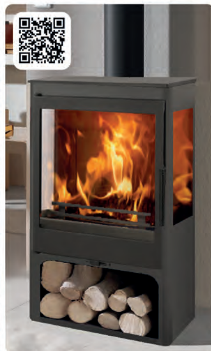
CORAL 3V 9702845 5,4 kw. Rendimiento 77%. 730 x 446 x 384 mm. Peso 68 kg. Doble cuerpo de chapa de 3+3 mm. Volumen calefacción 150 m 3 . Clase energética A.
