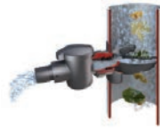
FILTRO PARA BAJANTE REDONDO 9653216 Tubo de conexión y broca de corona para perforar la bajante. De fácil instalación. Filtra la suciedad del tejado, conecta el bajante con el depósito y funciona de rebosadero.
